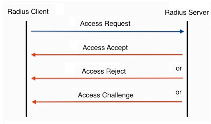
Figura 1: Intercambio básico de mensajes RADIUS.
